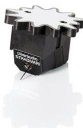
**Beschreibung:** Ebenholzkörper mit einzigartiger Geometrie (Resonanzoptimum), Micro HD Nadelschliff, Nadelträger aus verwindungsfreiem Bor, 24 Karat Goldspulen, Metall-Intarsie zur besseren Energieableitung. Systemgewicht: 7,0 g Output: bei 5cm/s / 0,6mV Impedanz: 50 Ohm
