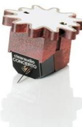
**Beschreibung:** Fernambuk Holzkörper mit einzigartiger Geometrie (Resonanzoptimum), Micro HD Nadelschliff, Nadelträger aus verwindungsfreiem Bor, 24 Karat Goldspulen, Metall-Intarsie zur besseren Energieableitung. Systemgewicht: 7,0 g Output: bei 5cm/s / 0,6mV Impedanz: 50 Ohm
