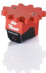
**Beschreibung:** Aluminiumkörper mit Keramikoberfläche, mit einzigartiger Geometrie (Resonanzoptimum), micro HD Nadelschliff, Nadelträger aus verwindungsfreiem Bor, 24 Karat Goldspulen. Systemgewicht: 7,0 g Output: bei 5cm/s / 0,6mV Impedanz: 50 Ohm
