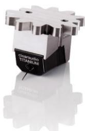
**Beschreibung:** Titankörper mit einzigartiger Geometrie (Resonanzoptimum), micro HD Nadelschliff, Nadelträger aus verwindungsfreiem Bor, 24 Karat Goldspulen. Systemgewicht: 9 g Output: bei 5cm/s / 0,6mV Impedanz: 50 Ohm
