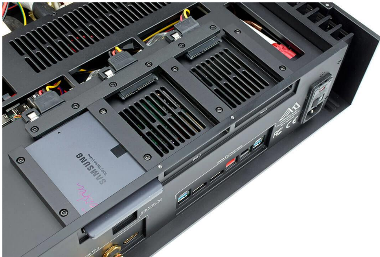
Praktické: Antipodes K50 ponúka tri externe prístupné sloty na inštaláciu 2,5-palcových pevných diskov
