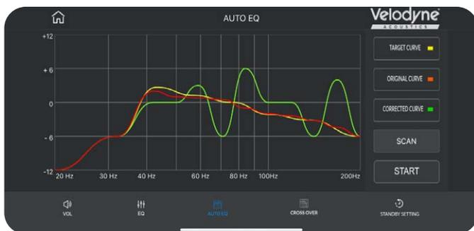
Im ersten Schritt der Raumeinmessung wird das Mikrofon nach oben gerichtet etwa einen halben Meter vor dem Subwoofer platziert. Nachdem man „Scan“ gedrückt hat, wird die Zielkurve ermittelt (Screenshot: AV-Magazin)
