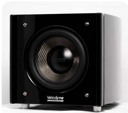
**Das Gehäuse wird aus HDF in Wandstärken zwischen 25 und 35 Millimetern gefertigt. Ein Frontrahmen, in den der Montagering des Treibers eingespannt wird, trägt vorne weitere 15 Millimeter Materialstärke auf (Bild: Velodyne Acoustics)**
