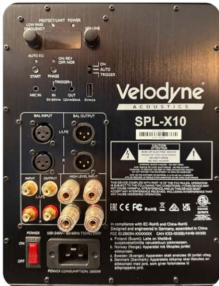
Anschlussseitig bleiben keine Wünsche offen, die Hochpegel-Eingänge und -Ausgänge sind auch symmetrisch ausgeführt. Die XLR- und RCA-Buchsen für den linken Kanal können LFE-Signal annehmen und durchschleifen (Bild: Velodyne Acoustics)
