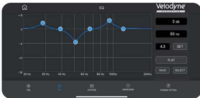
Der Equalizer ermöglicht eine sehr genaue Einstellung eines individuellen Klangprofils, erfordert aber etwas Fingerspitzengefühl. Um versehentlich vorgenommene Überhöhungen zu vermeiden, ist nur eine Anhebung um sechs Dezibel möglich (Screenshot: AV-Magazin)
