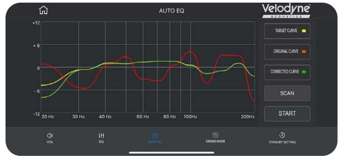
Schließlich stimmen beide Kurven fast überein, der Subwoofer ist nun optimal auf den Raum und seine Positionierung abgestimmt. Die Korrekturkurve wird automatisch an den DSP übermittelt (Screenshot: AV-Magazin)
