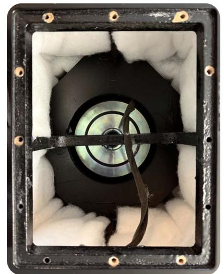
**Ein Blick in das Gehäuse ohne Rückwand und stützende Kreuzstrebe offenbart das gewaltige Magnetsystem (Bild: AV-Magazin)**
