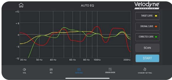
Jede weitere Abfolge von Testtönen und gleichzeitiger Messung nähert die Antwort im Raum der Zielkurve an, wobei die App abhängig von der Situation die Anzahl der Durchläufe festlegt (Screenshot: AV-Magazin)
