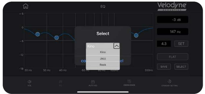
Für unterschiedliches Programmmaterial stehen mehrere gut abgestimmte Presets zur Verfügung, die modifiziert und neu benannt werden können (Screenshot: AV-Magazin)
